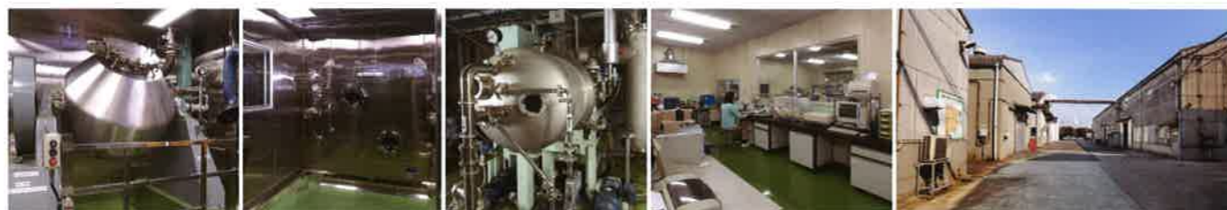
コニカルドライヤー 棚式乾燥器 遠心薄膜真空蒸発装置 品質管理室 ナードケミカルズ建屋
